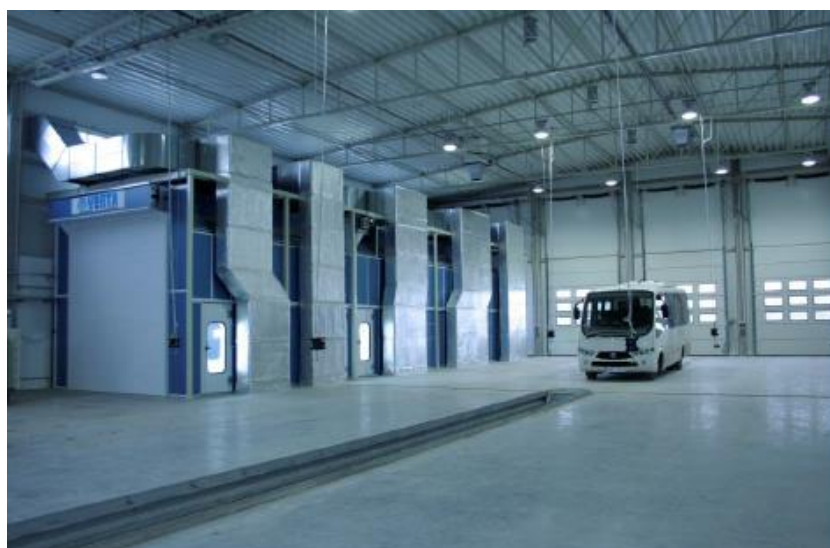
Przykład stanowiska komory lakierniczej z układem nawiewów i wyciągów. (Foto: Nova VERTA)
