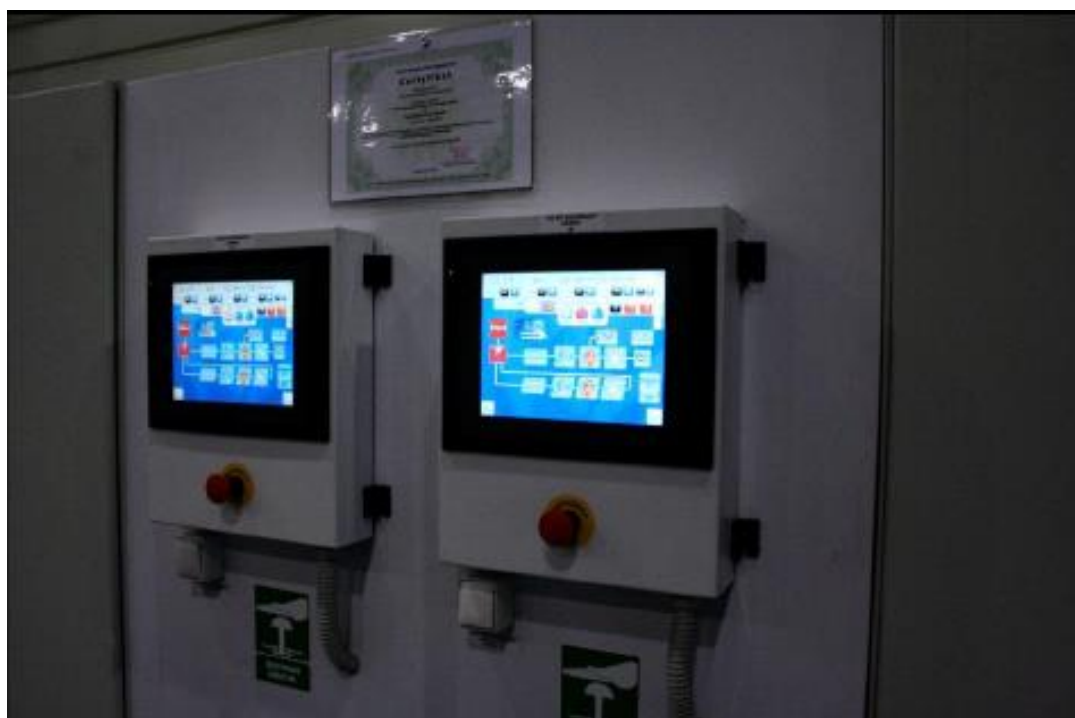
Wizualizacja systemu sterowania na monitorach sterujących parametrami pracy stanowisk przygotowalni i malarni. (Foto: Nova VERTA)
