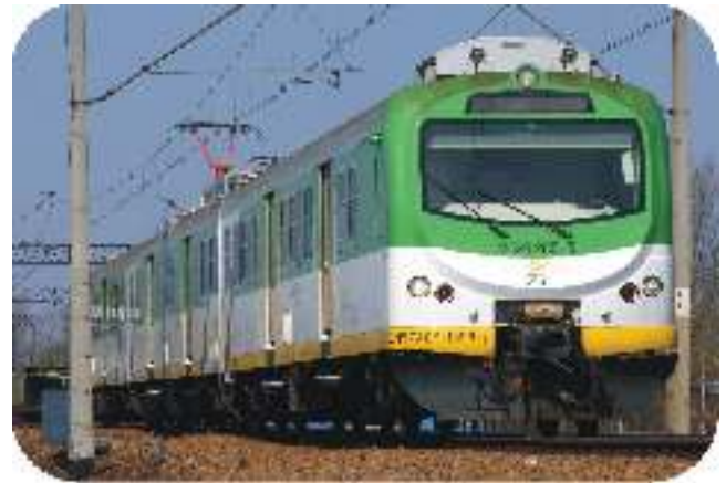
Elektryczny zespół trakcyjny EN57 AKM, czyli EN57 po naprawie piątego poziomu utrzymania i modernizacji
